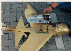
Mitglieder des Aereon-Teams bauten E-Motoren in die Modelle ein: Sie haben glänzende Flugeigenschaften
